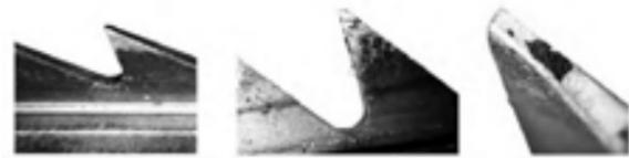
图1 传统刺辊针布使用状态
