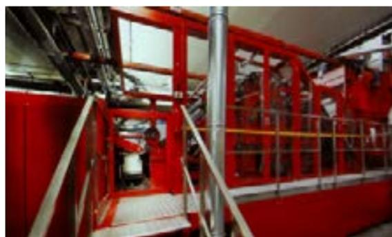
图3-4 Booster型梳理机设备图
