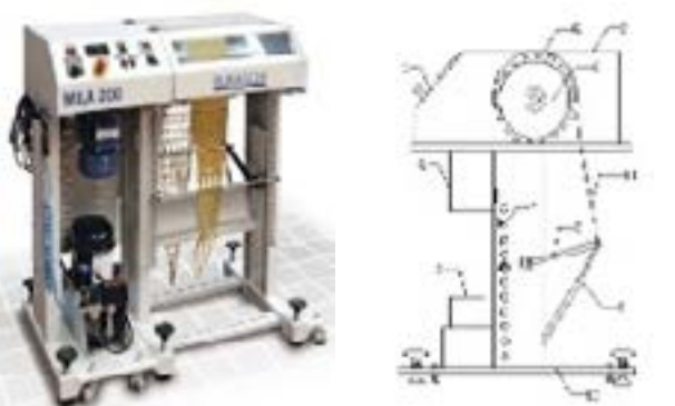
图2 MILA-200耐磨测试机及示意图
