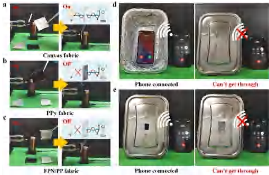
图6 不同织物(包括帆布织物、PPy织物和FP@CP织物)的电磁干扰(EMI)屏蔽效能: a-c 使用不同织物隔断屏蔽电磁以熄灭LED灯泡的摄影演示; d-e 使用金属唇和FP@CP织物屏蔽手机信号的摄影演示。
