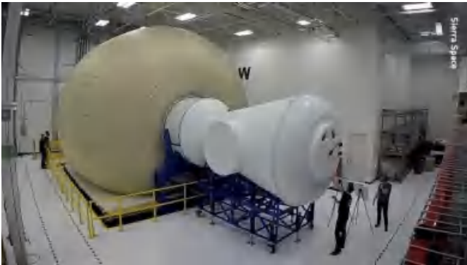
Sierra Space正在开发LIFE栖息地，这是一种由Vectran织物组成的充气耐压壳体，Vectran™ 织物是一种由液晶聚合物纱线编织而成的材料，在轨道上充气时比钢更坚固。
