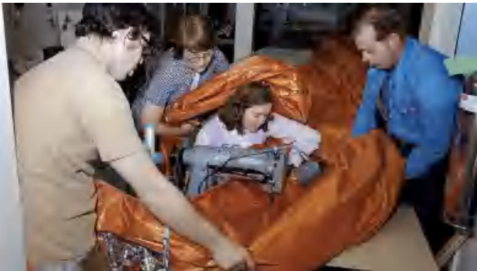
1973年，美国国家航空航天局（NASA）的裁缝阿琳·贝克（Aylene Baker）被拍到正在缝制“天空实验室”（Skylab）的替换隔热罩的一部分。在发射后不久，原隔热罩意外撕裂。这张照片如今在NASA约翰逊航天中心展出。
