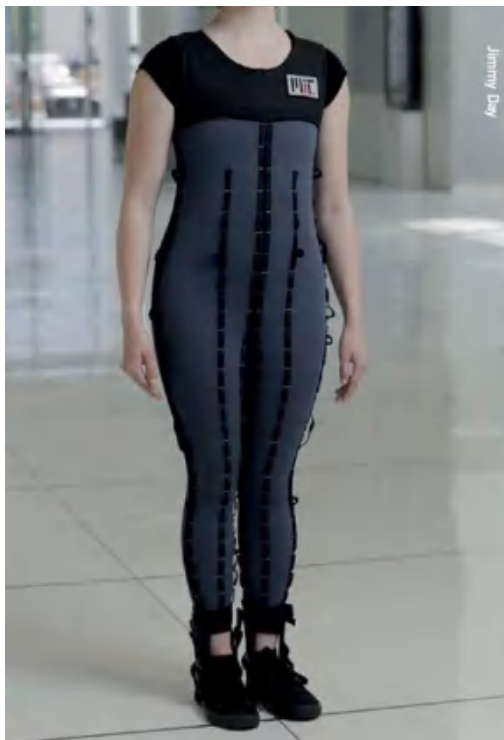
由麻省理工学院开发的重力载荷对抗紧身衣（Gravity Loaded Countermeasure Skinsuit, GLCS）旨在模拟部分重力效应，在未来的月球和火星任务中辅助锻炼。
