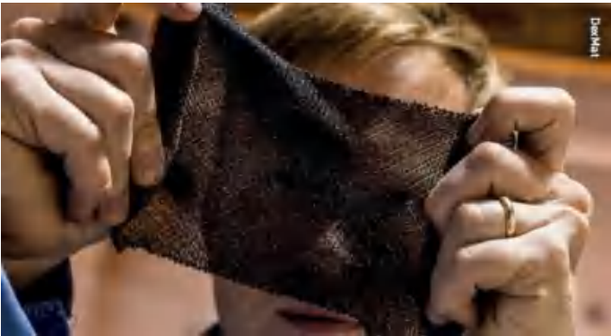
一个由Galvorn纤维编织成的小型方块织物。Galvorn比钢更坚固，比铝轻，并拥有铜的导电性。
